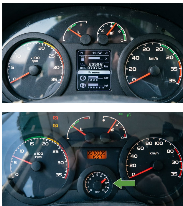
Figura N° 7. Tableros de los vehículos indicando el manómetro de presión de aire de freno
