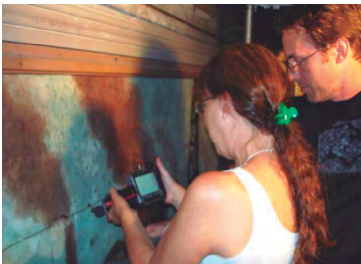
Figuras N° 8. Especialistas del INTI, realizando una termografía.
