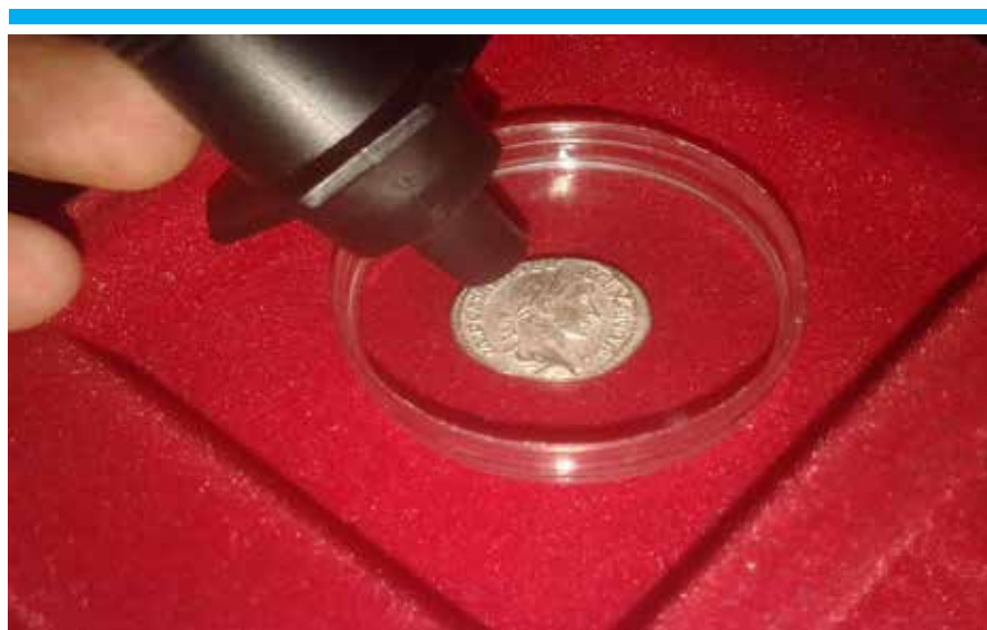
Fig. 20. Pincel magnético sobre la pieza dubitada. Fuente: Autor
