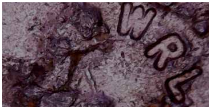
Fig. 17. Detalle de una reproducción de un denario de Septimio Severo, en donde se observa con aumento las siglas "WRL" (Westair Reproductions Limited), siendo las iniciales de los fabricantes de la pieza. Colección del autor.
