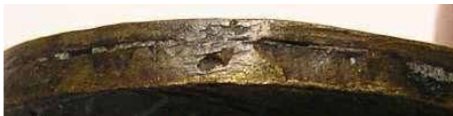
Fig. 12. Vista del canto de una falsificación producida por electrotyping, en donde se puede observar la costura, por la unión por soldadura de ambas caras. Fuente: http://www.imperio-numismatico.com/fake-coins-h49.htm
