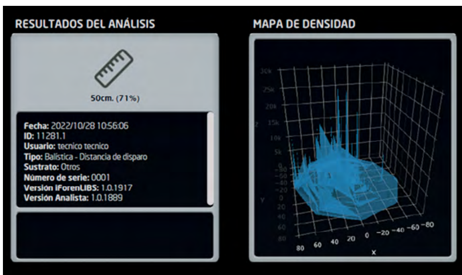
Figura N° 5. Imagen generada por iForenLIBS con un mapa de densidad respecto al plomo en 3D, donde se observa la distancia y la angulación.
