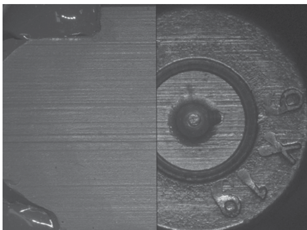
Figura N° 12. Documentación en yuxtaposición de las características transmitidas por el espaldón al molde SirchSil® de la pistola N° 11-606592 (izquierda) y la vaina servida testigo obtenida de la pistola N° 11-606588 (derecha). Fuente: producción propia.
