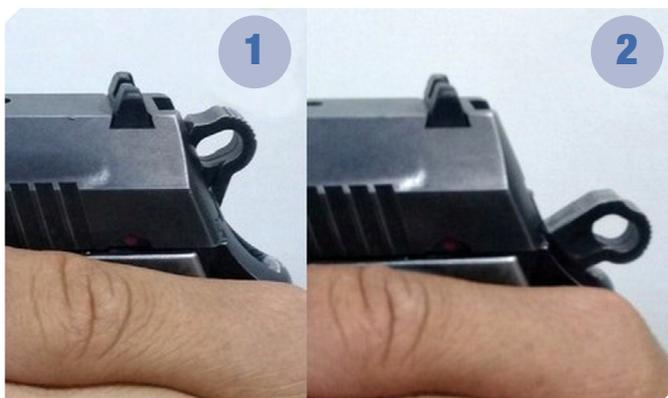
Figura 60. Martillo 1) desmontado y 2) montado. Fotografías propias
